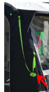
Compruebe que todas las válvulas están bien abiertas, con el extremo metálico en la posición On.
