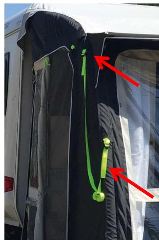
Los sujetadores de esquina deben plantarse a  $45^{\circ}$  de las costuras de las esquinas, los sujetadores a lo largo de los paneles deben plantarse a  $90^{\circ}$  de los paneles.
