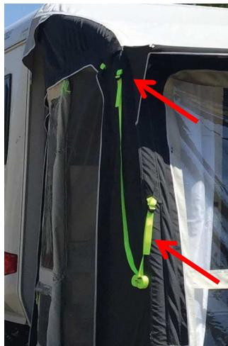
Nicht zu fest anziehen, da dies die Markise verformen kann, Eckbefestigungen sollten in 45° von den Ecknähten gepflanzt werden, die Befestigungen entlang der Platten sollten in 90° zu den Platten gepflanzt werden.
