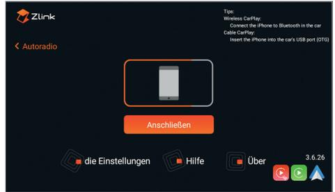
Schließen Sie das Smartphone mit dessen Ladekabel am USB-Anschluss 1 (runde Buchse) an. Die Verbindung wird dann automatisch hergestellt. Der Vorgang kann eine Weile dauern. Dabei wird eine bestehende Bluetooth-Verbindung deaktiviert und das Smartphone geladen.
