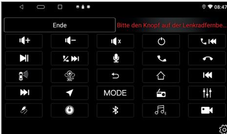
Drücken Sie nun einen Knopf/Taster oder betätigen einen Regler an der Lenkradfernbedienung.
