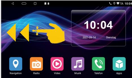
Das ESX Gerät verfügt über zwei frei belegbare Hauptmenüs, auf die Sie mit einer Wischbewegung nach rechts oder links zugreifen können.
