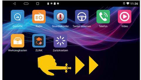
Über das Bedienfeld „Apps“ rechts unten gelangen Sie in die Appmenüs, auf die Sie mit einer Wischbewegung nach rechts oder links zugreifen können. Dort sind alle installierten Apps in alphabetischer Reihenfolge zu finden. Durch kurzes Antippen eines Symbols, starten Sie die jeweilige Anwendung. Durch kurzes Antippen eines Symbols, starten Sie die jeweilige Anwendung.
