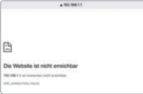
6. Wenn die Änderungen übernommen wurden, wird eine Browser-Fehlerseite angezeigt und Ihr Gerät ist nicht mehr mit dem Router verbunden. Da Änderungen am WLAN-Netzwerk vorgenommen wurden, wird der Router automatisch alle Geräte entfernen, einschließlich des Geräts, das Sie gerade verwenden.
