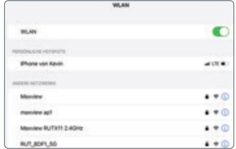
7. Sie können nun die WLAN-Einstellungen Ihres Geräts aufrufen und sich die verfügbaren WLAN-Netzwerke anzeigen lassen. Der Roam-Router wird unter dem Namen angezeigt, den Sie ausgewählt haben. Wählen Sie das Netzwerk aus und geben Sie das neue Passwort ein. Dieser Schritt muss für jedes Gerät wiederholt werden, das Sie mit dem Netzwerk verbinden möchten.
