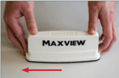
7. Drücken Sie die Antenne fest auf das Dach speziell an den Kanten und stellen Sie sicher, dass eine wasserdichte Abdichtung erreicht ist.
