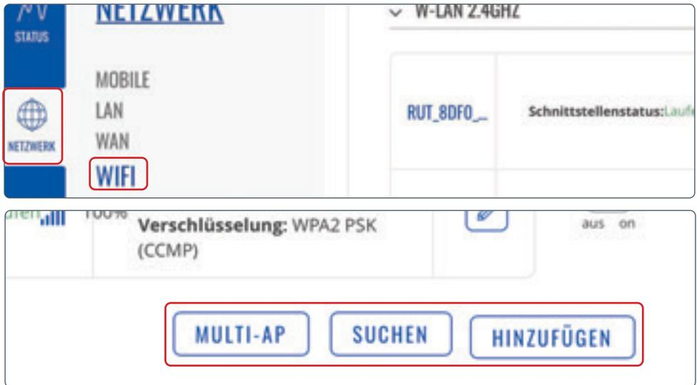
1. Rufen Sie „Netzwerk“ und danach „WiFi“ auf. Von hier aus können Sie sich alle WLAN-Verbindungen ansehen, die unter dem Punkt Wireless Station Mode angezeigt werden, und sie verwalten. Das umfasst die Aktualisierung des WLAN-Passworts und das Löschen von Verbindungen, die nicht mehr benötigt werden.
