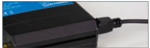
4. Schließen Sie den 12V-Anschluss oder das 230 V Netzteil (optional) an und verbinden Sie das Kabel mit Ihrer Stromquelle.
