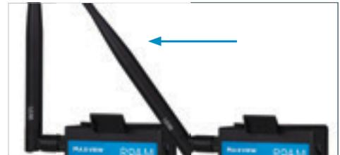
Die optimale Positionierung für die WLAN-Antennen an dem Roam Router ist senkrecht nach oben. Die Antenne am Router können jedoch auch so montiert werden wie auf dem Bild oben gezeigt im 45°- oder 90°-Winkel oder nach unten oder vorne zeigend.
