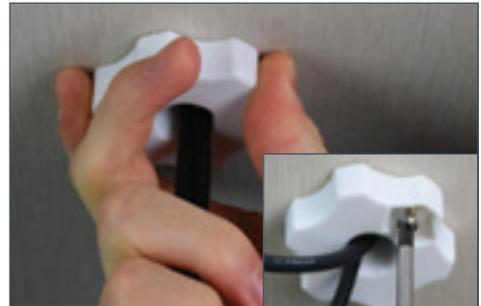
8. Befestigen Sie die Hohlschraube vom Fahrzeuginneren aus und ziehen Sie sie gegen den Uhrzeigersinn am Schraubgewinde fest, das aus der Unterseite der Antenne hervorragt. Drehen Sie so lange, bis die Hohlschraube das Montagepad unter
