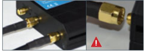
2. Verbinden Sie die Koaxialkabel der Antenne mit dem 2m Verlängerungskabel. Befestigen Sie dann die verbundenen Kabel mit dem Router an den unteren 2 Anschlüssen. Diese sind gekennzeichnet mit 'Mobile'. die Anschlussreihenfolge der Kabel spielt keine Rolle. **Alle Anschlüsse müssen im Inneren des Fahrzeugs sein.**
