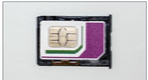
3. Nehmen Sie das SIM-Kartenfach heraus, und legen Sie die SIM-Karte in Standardgröße flach mit der Metallchip-Seite nach oben ein. Vergewissern Sie sich, dass die Sim-Karte ausgerichtet ist und vollständig flach in der Halterung liegt.
