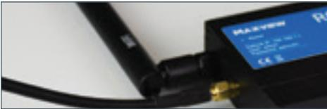
3. Schließen Sie die WLAN-Antenne am oberen Anschluss an. Er ist mit dem Wort „Wi-Fi (WLAN)“ beschriftet. Sie muss vertikal ausgerichtet werden.
