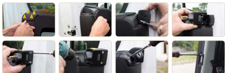
Abschließbarer Drehknopf / Drehknopf mit Arretierung
