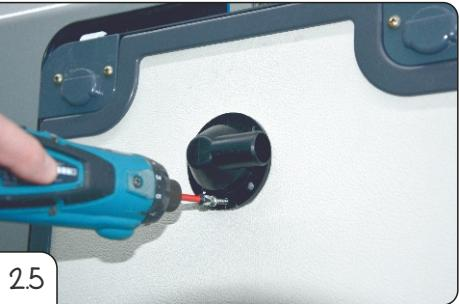
**2.3** De filterbehuizing moet minstens 5 mm van het deurframe worden aangebracht. Als montagehulp tussen deurframe en filterbehuizing 5 mm vlak materiaal houden. Schroeven, 3,5 x 16 VA zonder voorboren in de aluminiumplaat draaien en aanspannen. (Bij met glasvezel versterkte kunststof voertuigen 2,5-3 mm voorboren).
