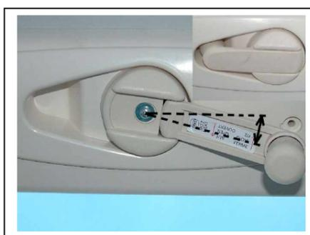
Beim Schließen mit der Handkurbel soweit drehen, bis Widerstand ebenfalls spürbar ist. Vor dem Einklappen der Kurbel muß eine leichte Vorspannung an der Kurbel vorhanden sein. Verriegelung überprüfen (durch Anheben der Glaskuppel mit der Hand).
